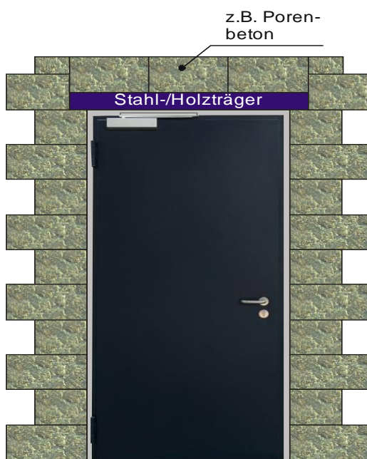
Abbildung 6: Stahl-/Holzträger als Sturz
